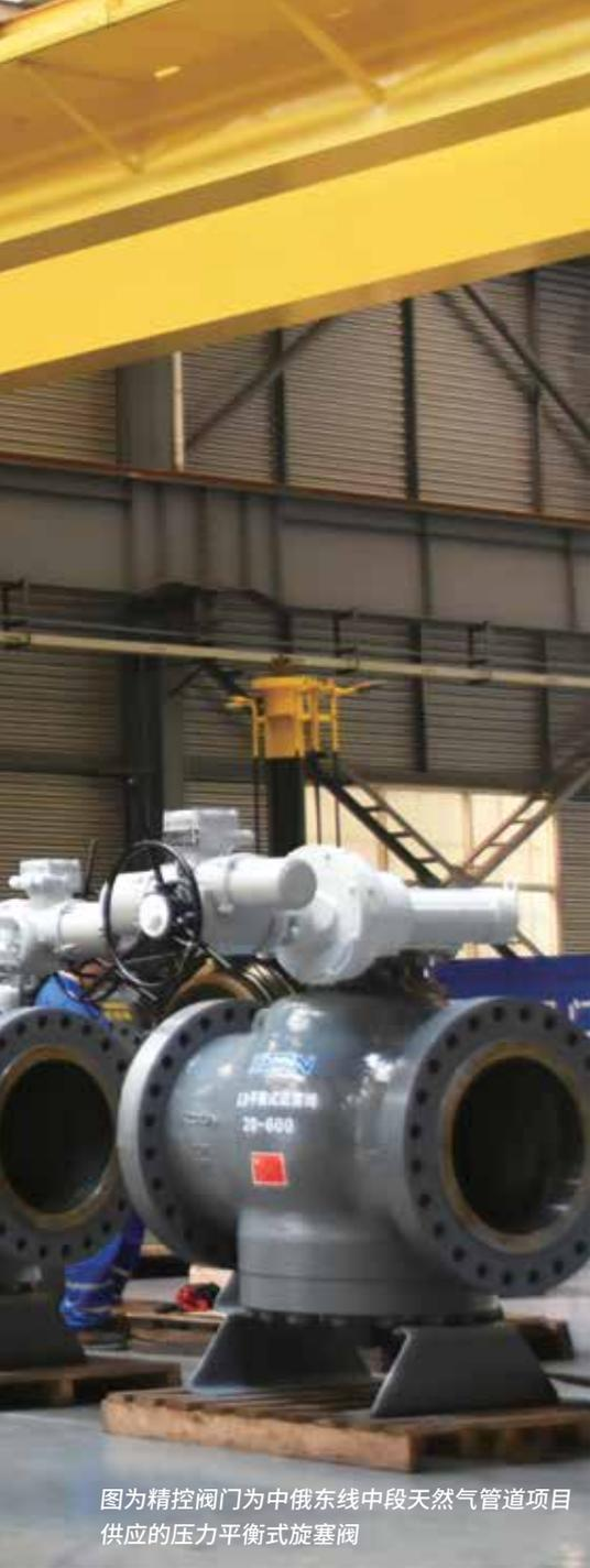
图为精控阀门为中俄东线中段天然气管道项目供应的压力平衡式旋塞阀
