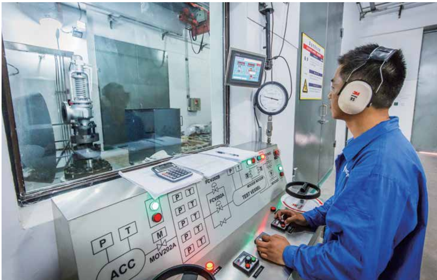
安全阀蒸汽测试中心2号蒸汽试验台架，可对大尺寸安全阀进行设定压力、回座、泄漏和排量试验
