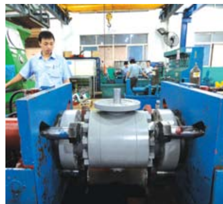
高压硬密封球阀压力测试
